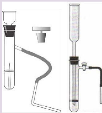
Рис. 7. Прибор для получения и собирания газов
