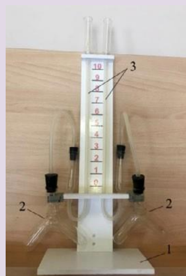
Рис. 4. Прибор для демонстрации зависимости скорости химических реакций от различных факторов: 1 — подставка; 2 — сосуда Ландольта; 3 — манометрические трубки
